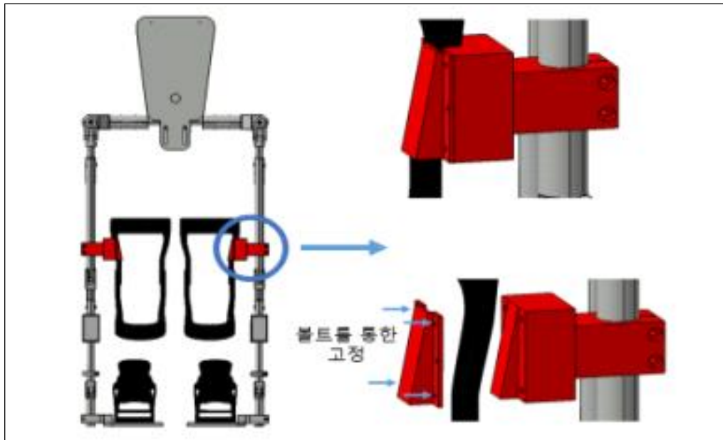
[그림 2.23] 인체접촉부(허벅지) 설계
