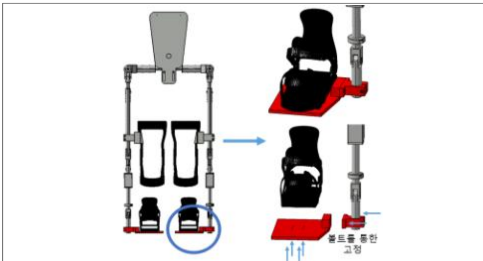
[그림 2.26] 인체접촉부(발) 설계 설계
