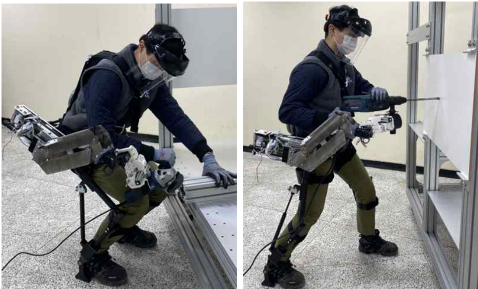
[그림 2.70] 통합 시작품을 이용한 그라인딩 및 드릴링 작업
