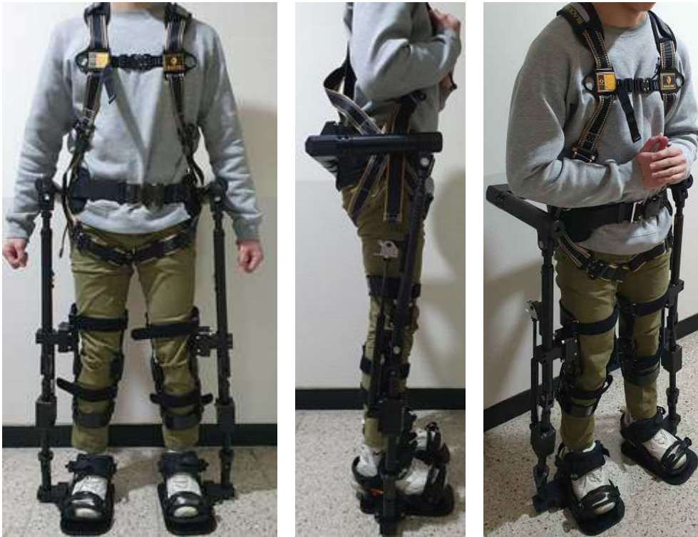
[그림 2.51] 1차연도 하지 보조 시스템(22.6kg)
