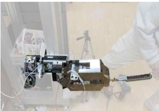
외력 저항 자세 유지 구동 시험 모습
