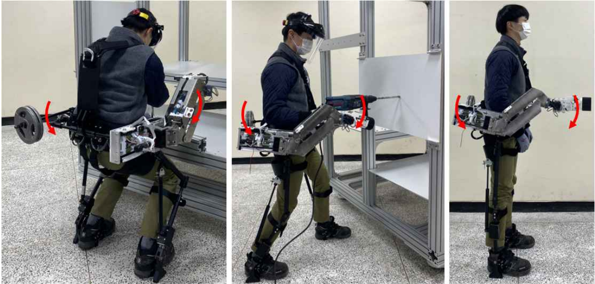
[그림 2.69] 자율 구동 관절 로봇과 카운터 밸런스의 균형
