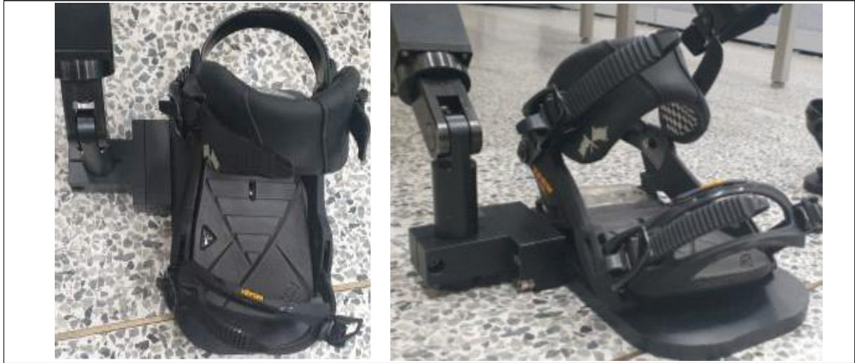
[그림 2.28] 발 접촉 장비 외골격 로봇 장착
