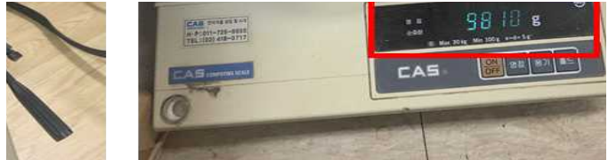
[그림 2.73] 허용하중 10kg 시험 모습
