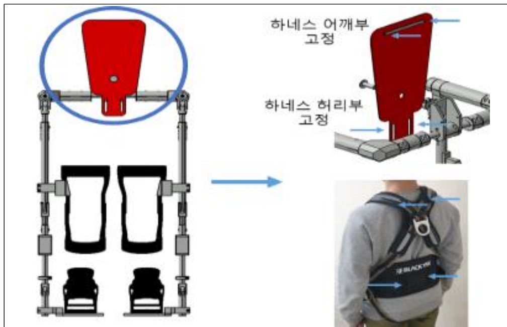
[그림 2.19] 외골격 로봇 상체 접촉부 조립 설명도
