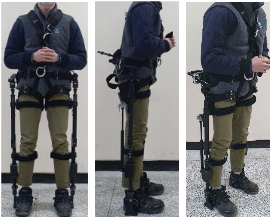
[그림 2.52] 2차연도 하지 보조 시스템(13.6kg)
