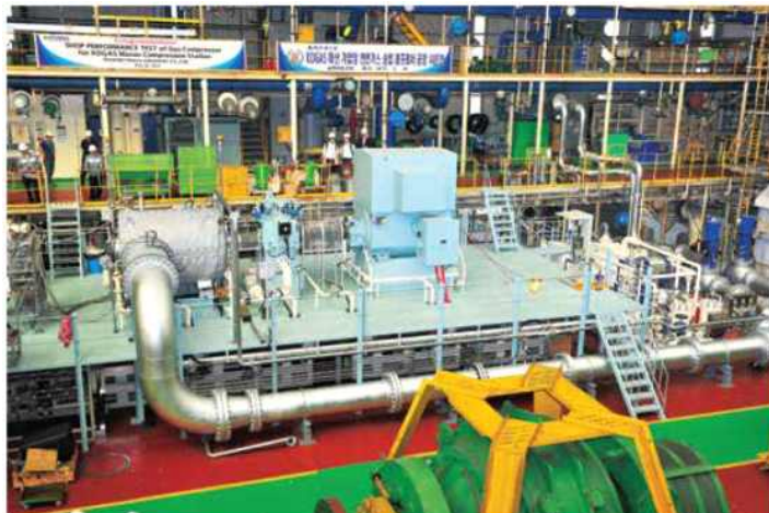
< 현대중공업터보기계 사의 barrel type 가스압축기 시험리그 >
