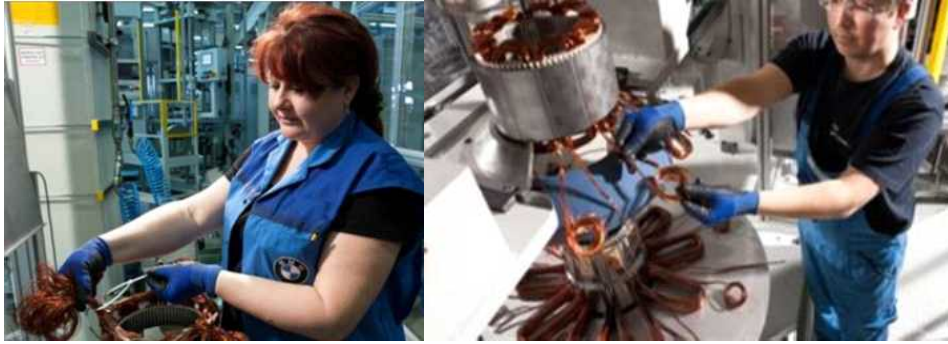
<그림 33> BMW 社の i8모델에 적용된 영구자석형 구동 모터의 양산 공정
