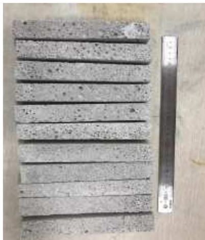
그림 41. 다공성 콘크리트 de NOx 필터 시작품 제작
