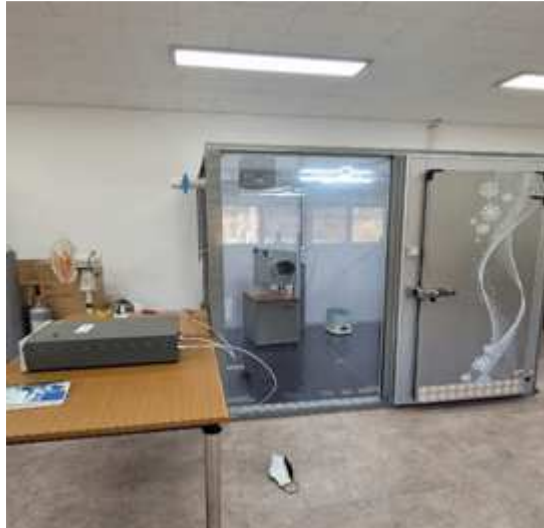
그림 89. 광촉매 필터 모듈 시작품의 챔버 테스트
