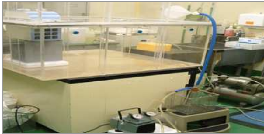
그림 20. de NOx 다공성 콘크리트 광활성 필터 모듈 시작품의 NOx 저감 평가 예
