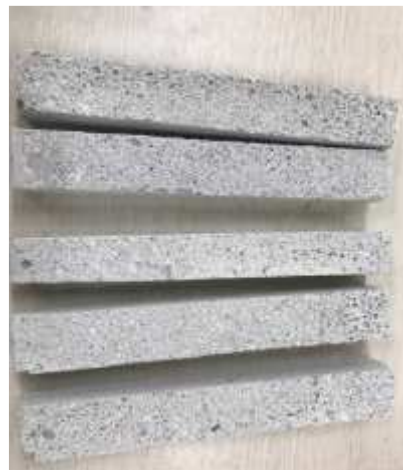
그림 41. 다공성 콘크리트 de NOx 필터 시작품 제작
