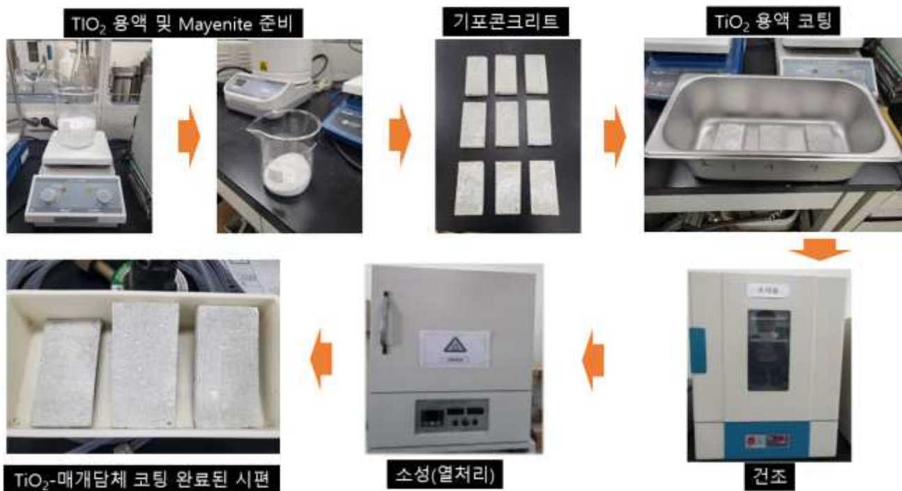
그림 67. 제법이 확립된 TiO_2 -매개담체의 기포콘크리트 표면 코팅에 관한 과정의 이미지
