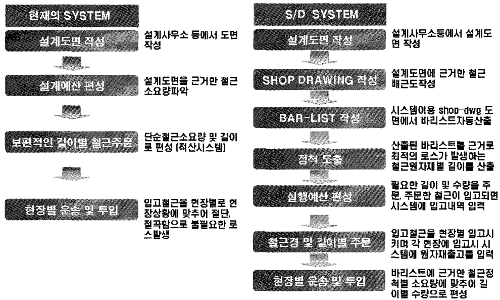
그림 3.29 설계도면과 배근시공도에 의한 철근공사 절차
