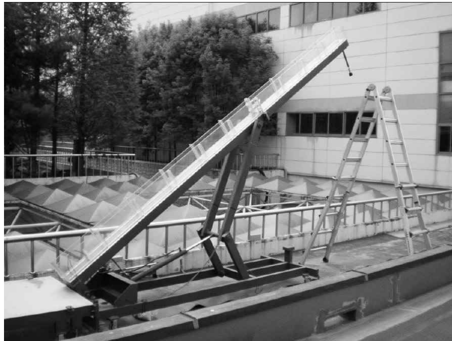
그림 1.8 토석류 충격력 모의실험 장치(김진환 등, 2010)
