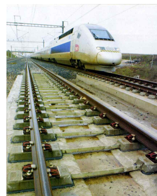
<프랑스 동부유럽선 고속철도에 시험 적용된 STEDEF 개량형 궤도구조>
