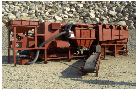
그림 3.4-6. Plastic media를 이용한 대용량 건식세척장치
