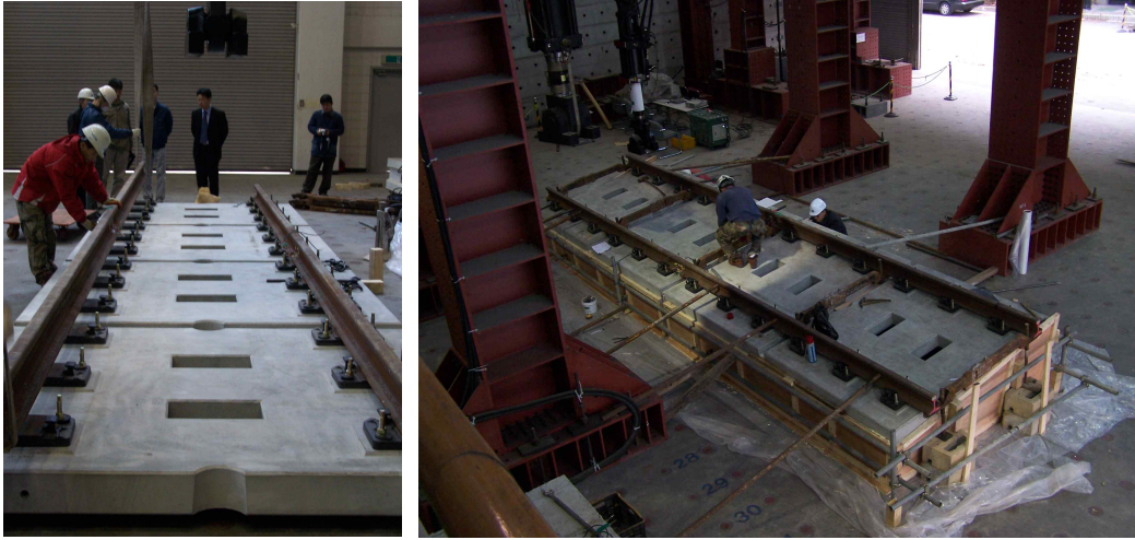
그림 2.4-26. 프리캐스트 콘크리트 슬래브를 이용한 자갈궤도 교체공법 실내실험 전경 (장승업 외, 2005)
