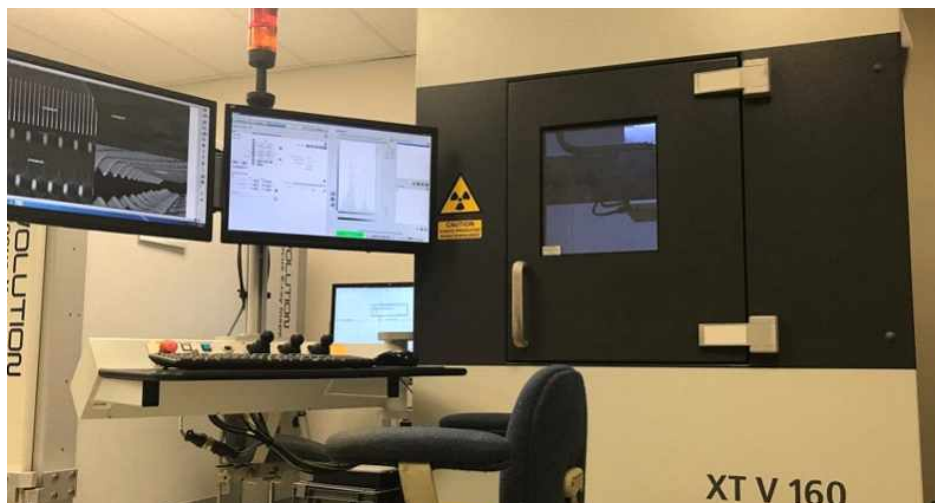
[그림 3-45 Micro CT, Nikon Metrology X-Tek 장비]
