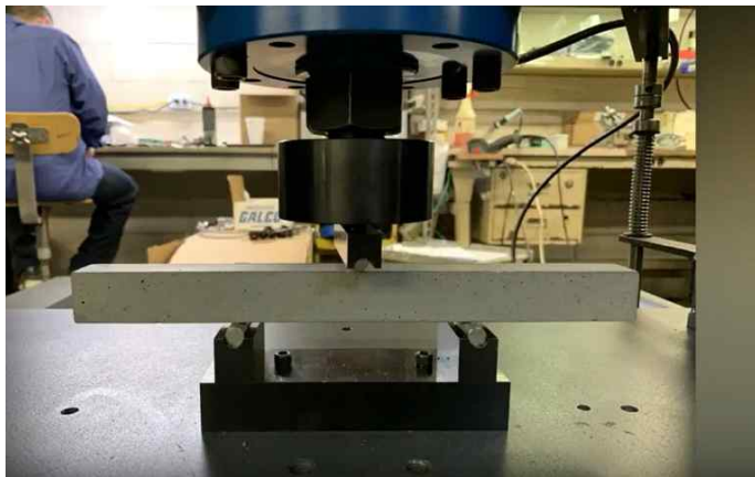
[그림 3-36 모르타르 휨강도 시험 과정]
