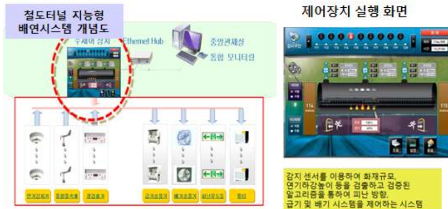
<그림 3 철도터널용 지능형 배연시스템 개념도>
