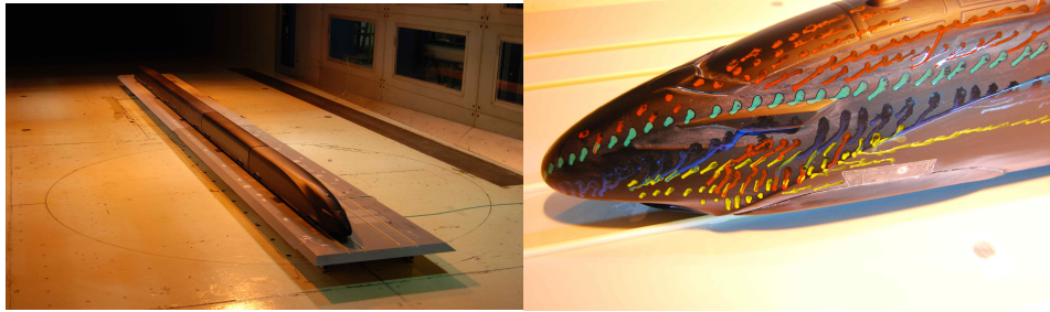
<HEMU-400x 1/20 축소모델과 개활지 모델(좌), 유동 가시화 실험(우) (차세대고속철도기술개발사업)>
