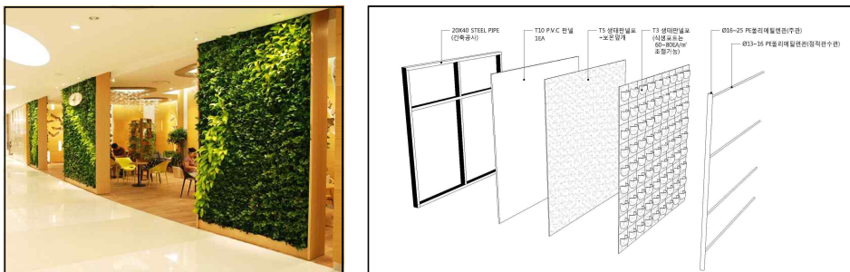
그림 12. 에코플랜터 설치 사례 및 제품 구조 개념도
