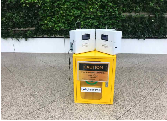
그림 176. 시제품 운전/비운전 시 24시간 실내공기질 측정
