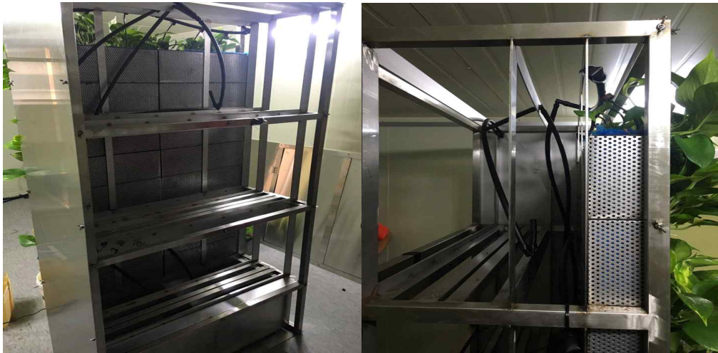
그림 154. 2차 챔버 및 EM활성액 Pure-water 200배 희석액 분사 호스
