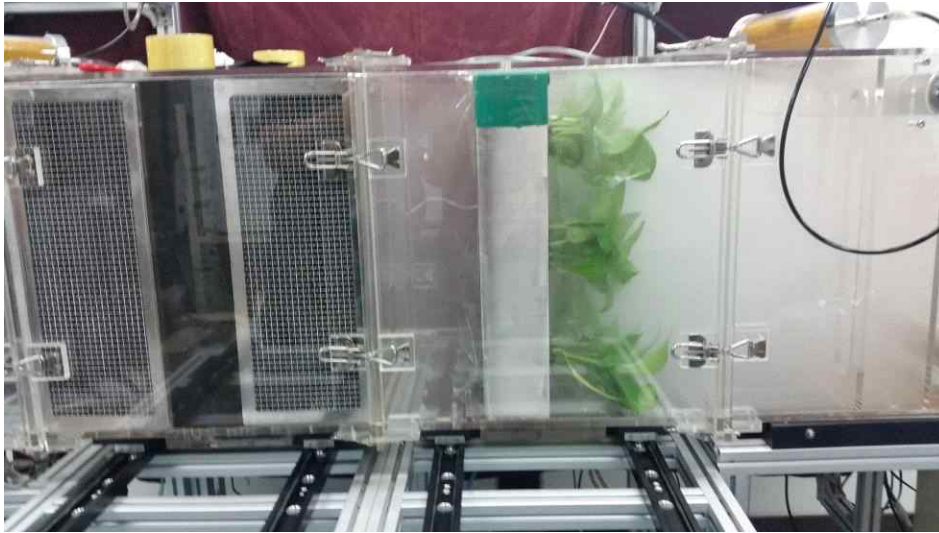
그림 61. Flow Marker 공기흐름 및 기밀성 확인
