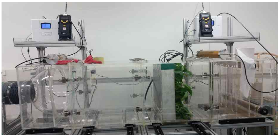
그림 35. 필터 수분 사용 시 안정화 확인 실험현황
