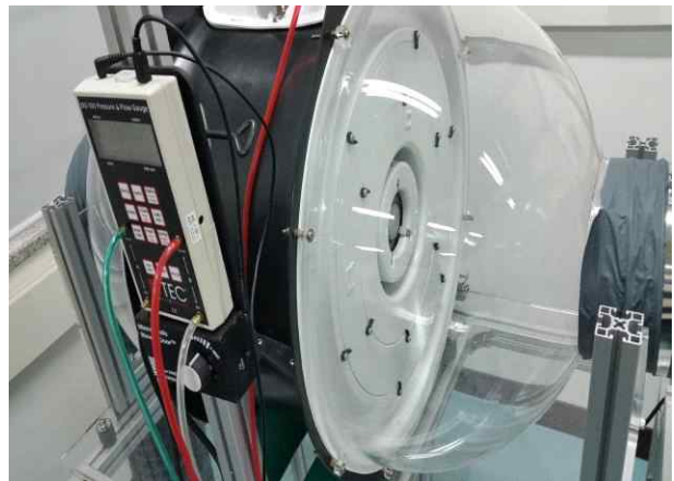
그림 53. Blower door 설치 상황
