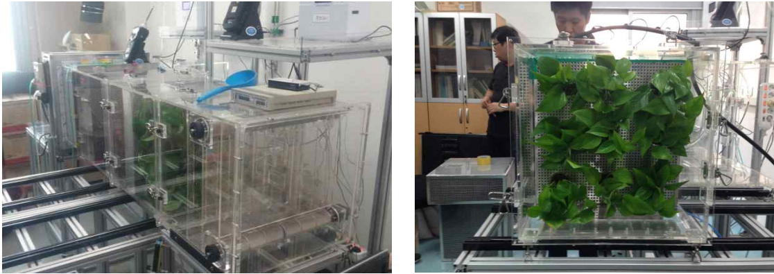
그림 113. 미세먼지 제거율 측정실험 (2차년도)
