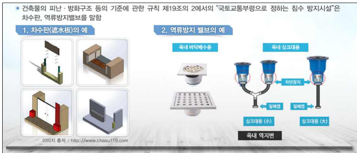
그림 2-1. 차수판 및 역류방지밸브의 예
