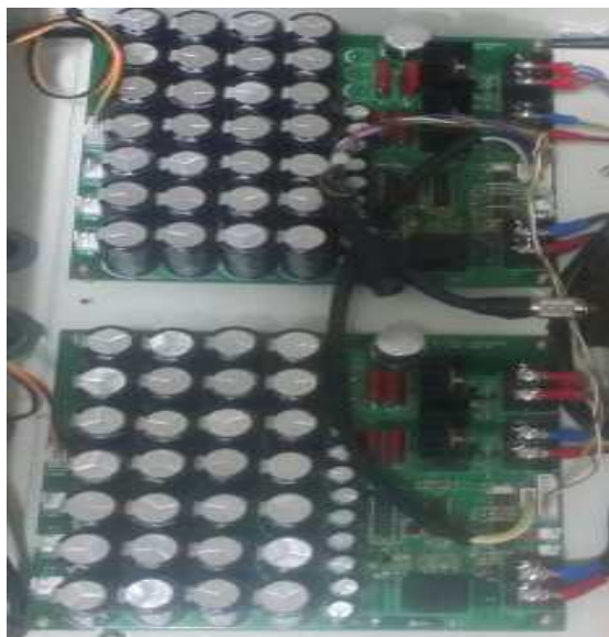
그림 25) IR LED 컨트롤러 하우징 내부
