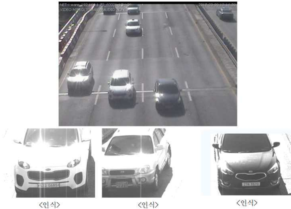
그림 93) 3차로용 Multi-lane ANPR 차량 동시진입 인식 여부 확인
