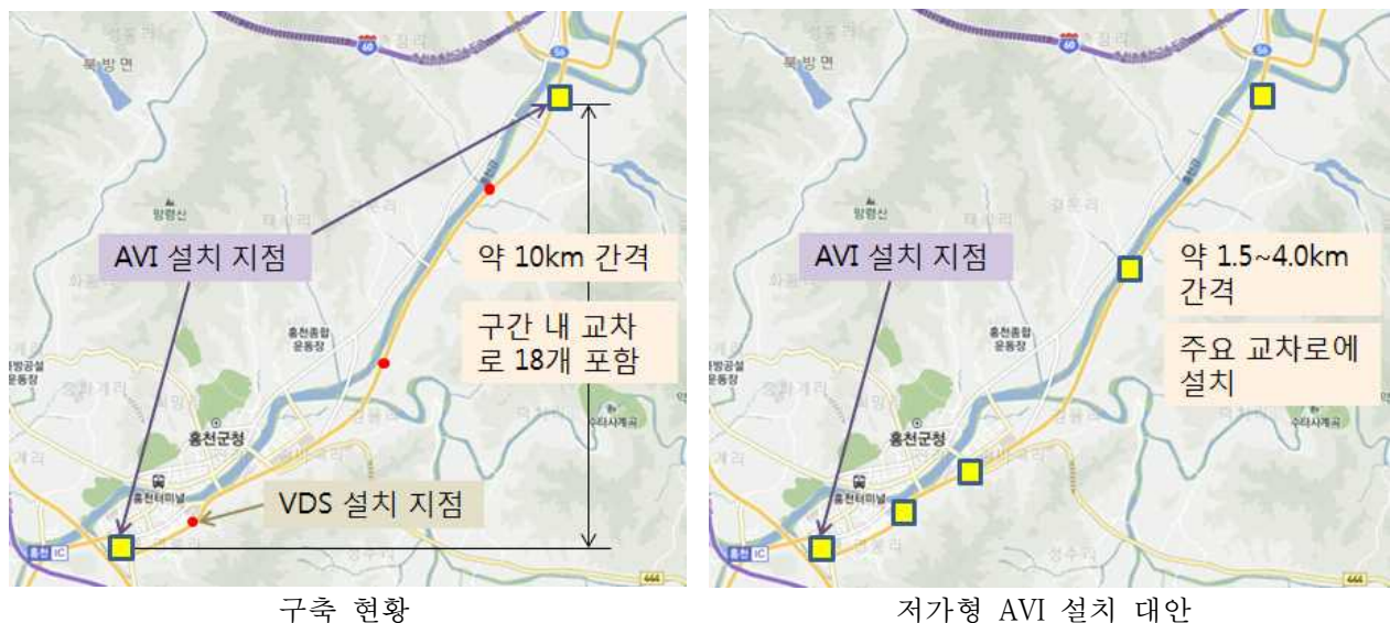
그림 3) 국도 ITS AVI 설치 사례(국도 44호선)
