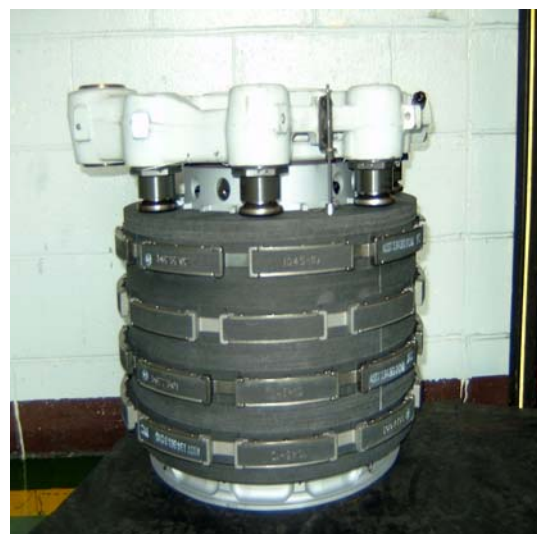
그림 6. 탄소-탄소 브레이크 디스크가 적용된 제동장치(B777 용)
