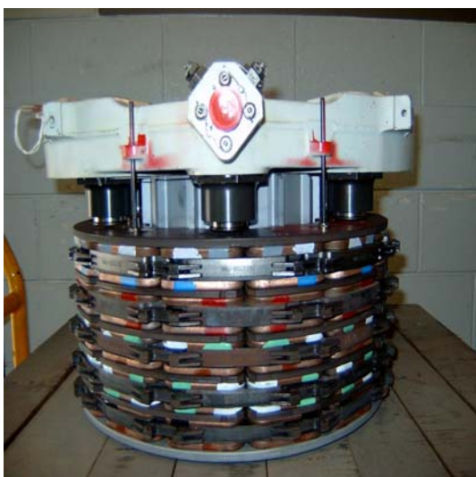
그림 5. 금속-금속 브레이크 디스크가 적용된 제동장치(B737 용)
