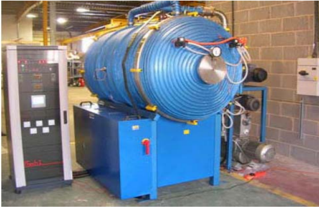
그림 39. 브레이크 디스크 제작을 위한 화학증기침투노(CVI furnace)
