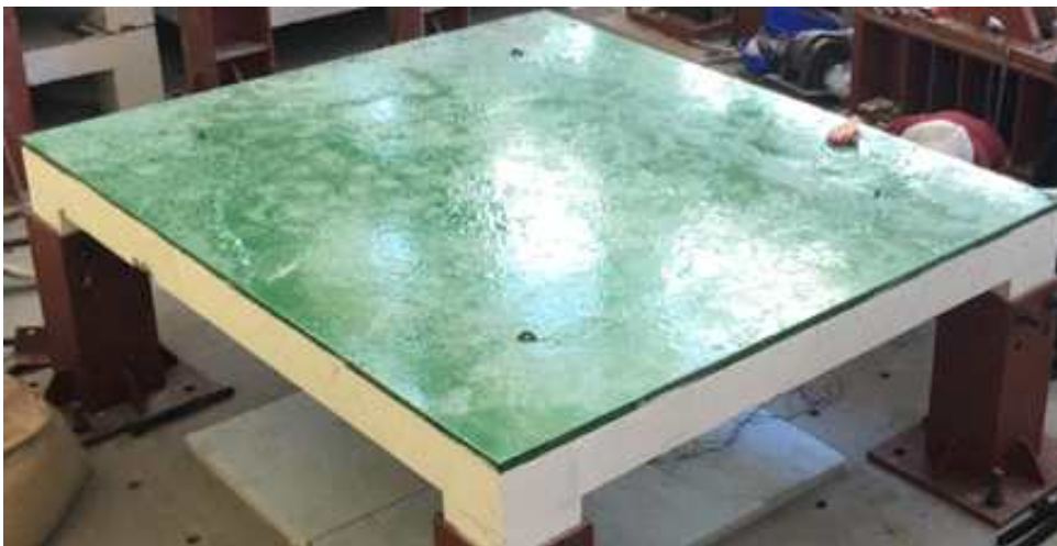
그림. 철골기둥을 이용한 하부 구조 생성
