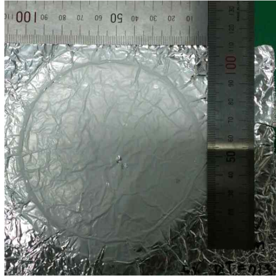
그림. 전기방사로 제작된 디스크 형태의 나노 섬유 매트: 지름 10 cm
