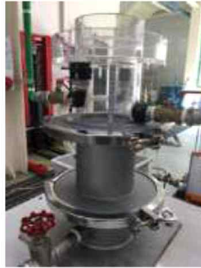
그림 3 투수성능 시험기 조립 상태
