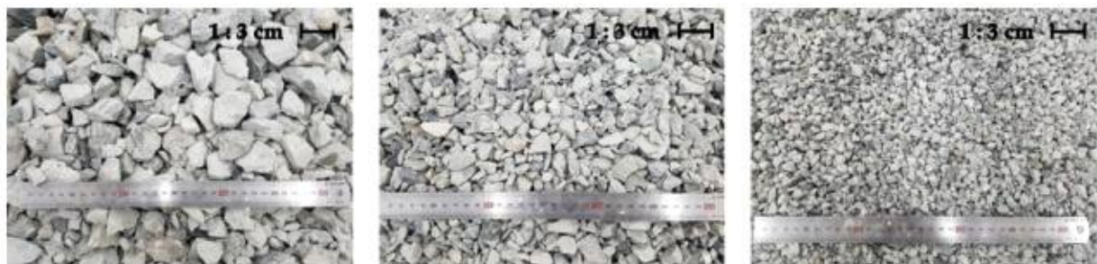
(a) D40(최대입경 40 mm) 골재 (b) D25(최대입경 25 mm) 골재 (c) D13(최대입경 13 mm) 골재
