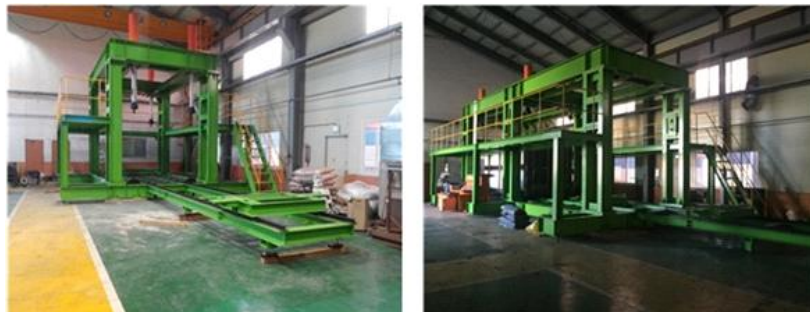
그림 86. 40ft 컨테이너 내력 시험기로 확장 (좌)20ft 내력시험기 / (우)40ft 확장된 내력시험기
