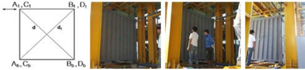
그림 37. 접이식 컨테이너 2차 시작품(경량화 시작품) - 가로방향 레킹 시험
