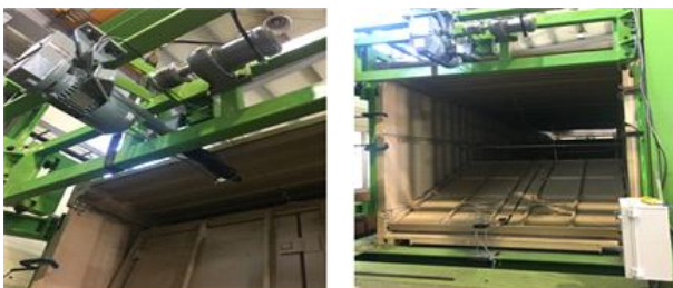
그림 120. 하중부여 조건의 후면부 패널 폴딩 신뢰성 시험
