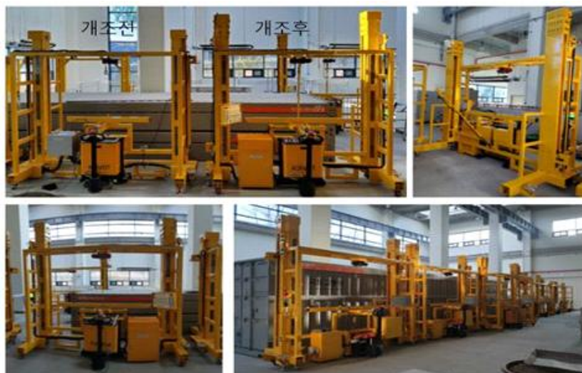
그림 162. 성능개선 완료된 일반(STD) 및 H/C 겸용 접이장비
