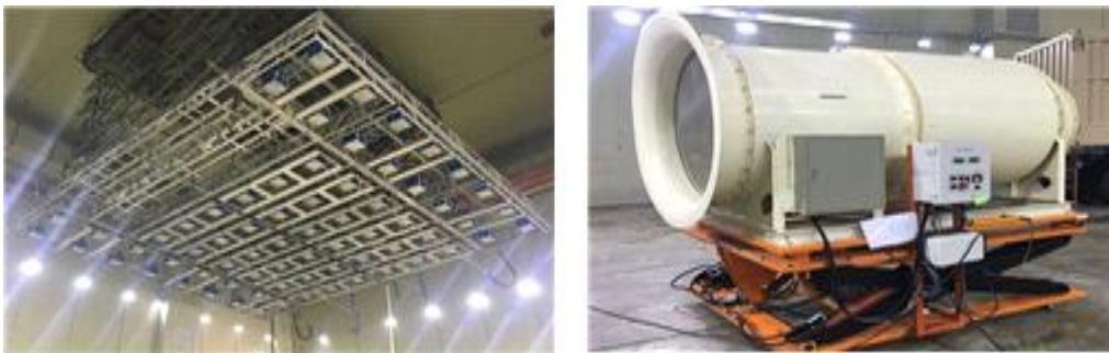
그림 122. (좌)강우 재현 시험기 (우)강풍 재현 시험기
