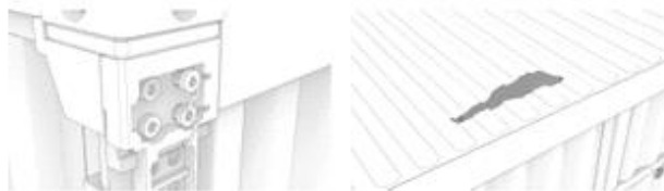
상부 모서리 쇠간의 정렬 / 결속부의 볼트, 롤링방지 스프링 체결 상부레일 휨 손상 / 레일과 판넬 연결부 찢어짐이나 누수
