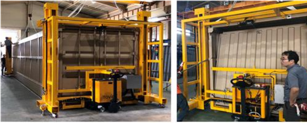
그림 117. 접이 장비에 의한 전/후 패널부 폴딩 기능 분석
