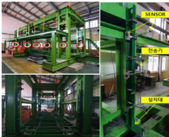
그림 113. 내력시험기 무인계측시스템 구축모습
