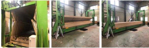
그림 119. 하중부여 조건의 폴딩(접고-펴기) 신뢰성 시험
