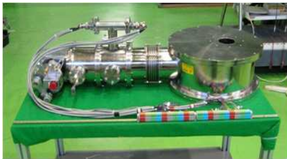
(a) 전도냉각방식의 2T급 고온초전도전자석 (b) Maglev용 초전도 하이브리드 전자석 (한국전기연구원) (한국철도기술연구원)
