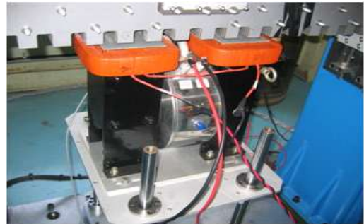
(a) 전도냉각방식의 2T급 고온초전도전자석 (b) Maglev용 초전도 하이브리드 전자석 (한국전기연구원) (한국철도기술연구원)
