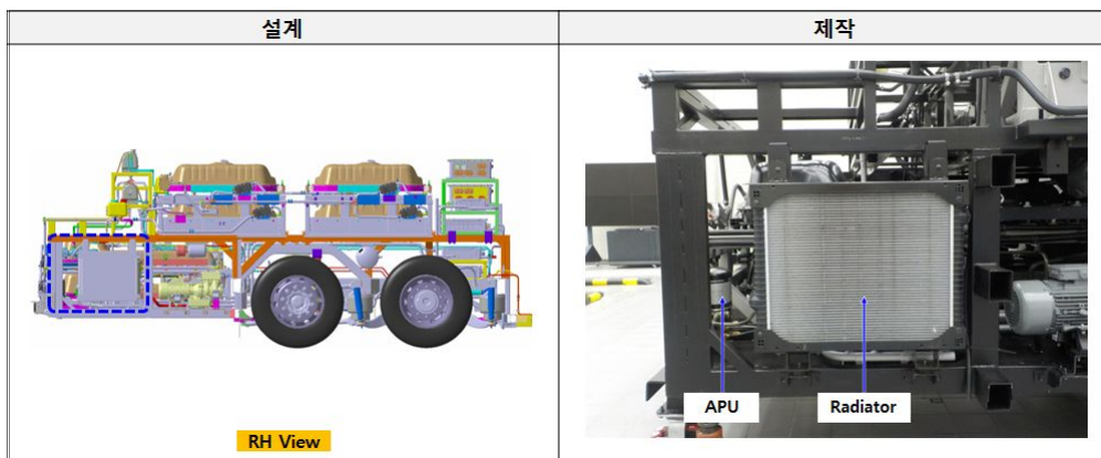
그림 53. 2층 전기버스 베어샤시 차량 RH 하단부 (뒷측) 구성
