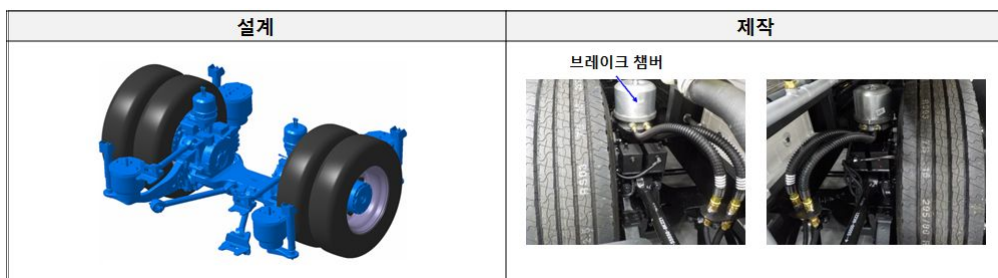
그림 58. 2층 전기버스 베어샤시 2축 휠모터액슬 구성
