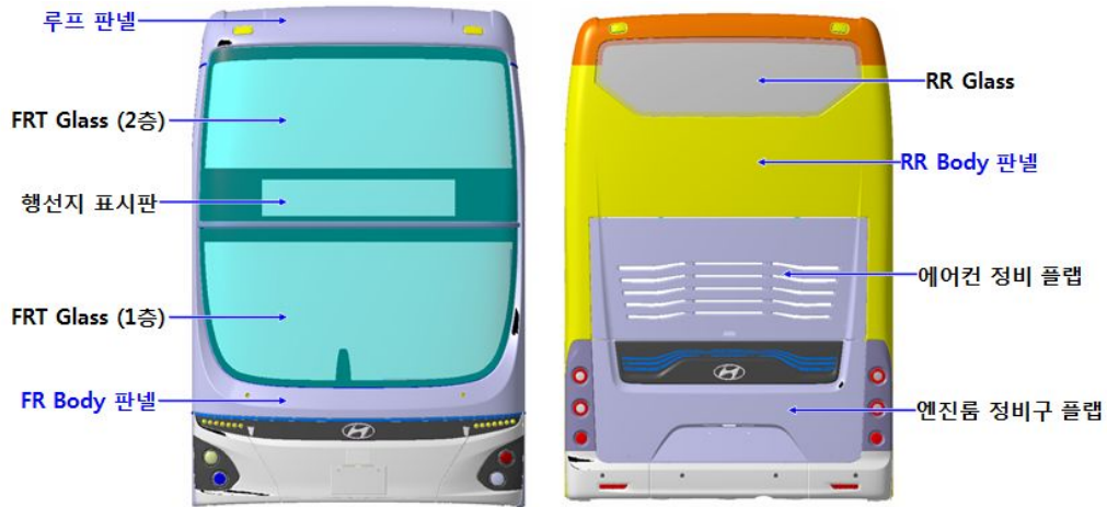
그림 61. 2층 전기버스 FRT/RR Body 판넬 구조
