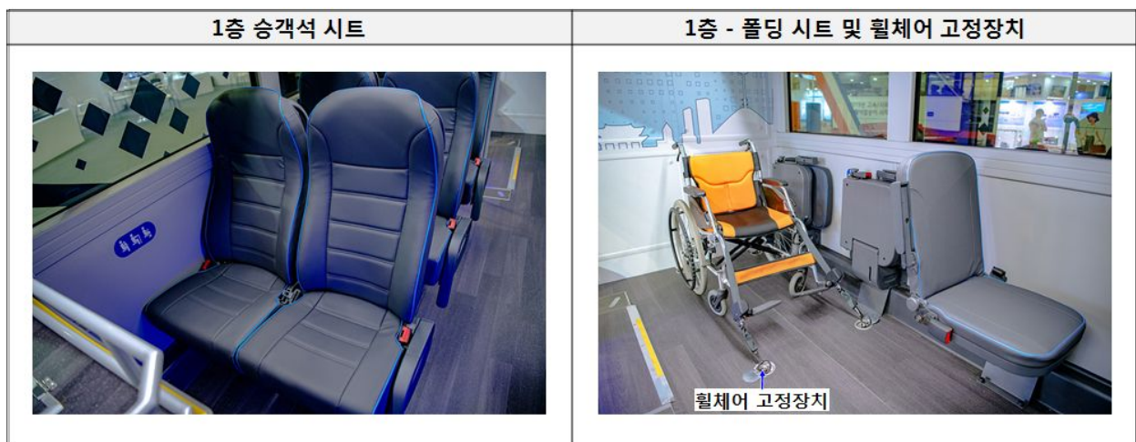
그림 92. 2층 전기버스 선행차량 1층 승객석 시트 및 휠체어 탑승 공간
