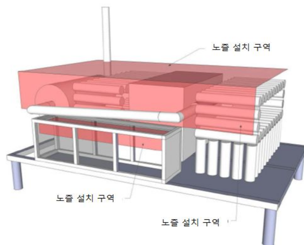
그림 177. 시험 장치의 뒷면에서 본 노즐 위치
