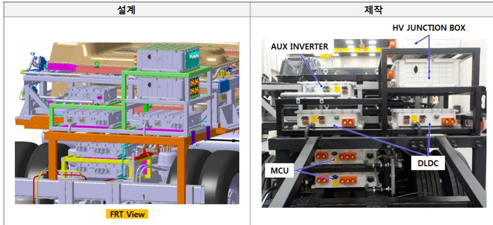
그림 49. 2층 전기버스 베어샤시 PE 부품 구성
