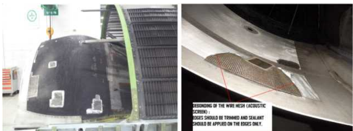
그림 44. 역추진장치 Wire Mesh 수리 예
