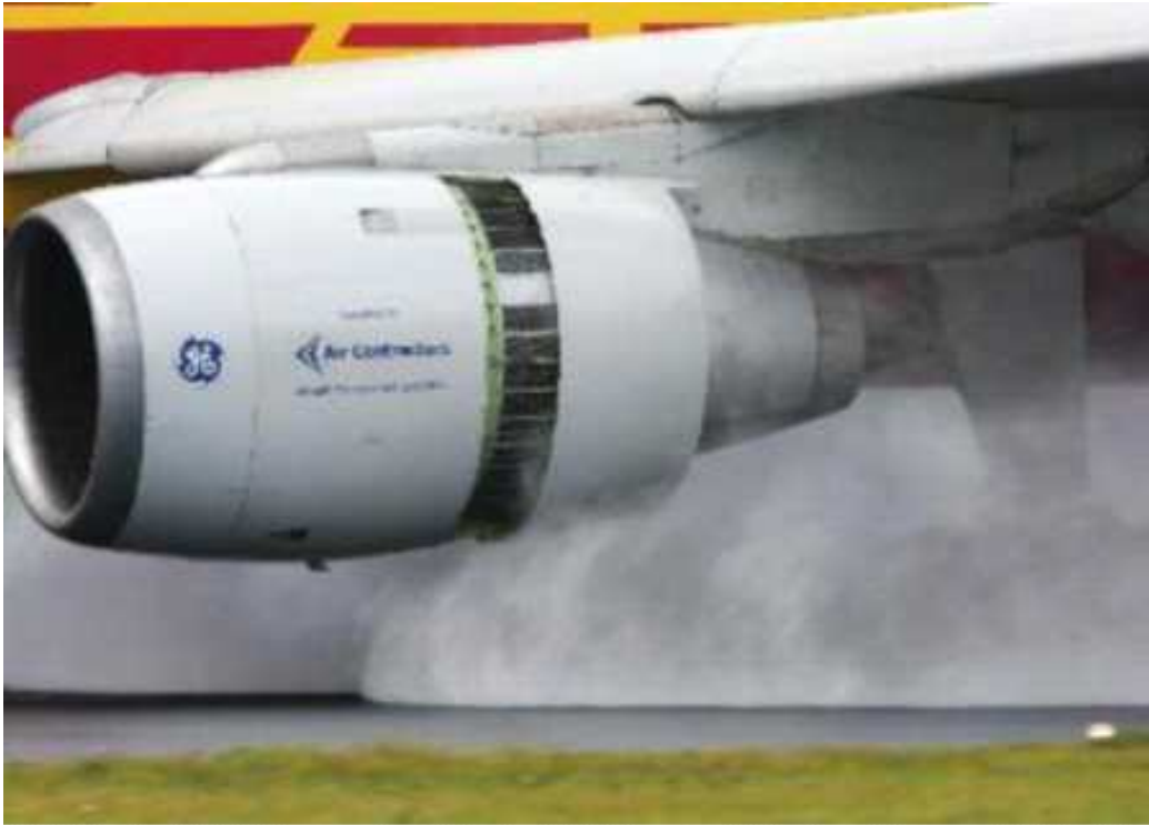
그림 89. CF6 엔진 Thrust Reverser 작동
