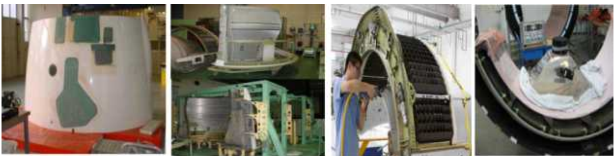
그림 22. 역추진장치 수리 정밀 조립/분해 Jig Fixture 및 수리공정 예
