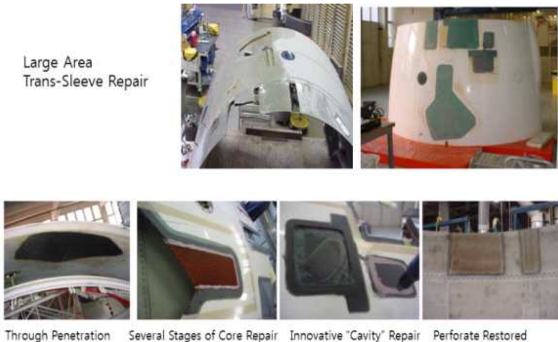
그림 46. 엔진 역추진장치 Patch 수리 예
