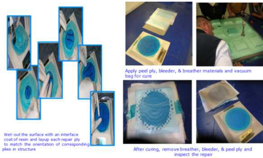
그림 51. Wet Lay-up Repairs
