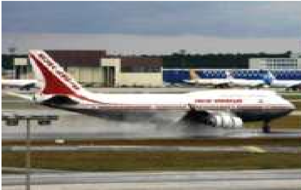
그림 8. B747-400 역추진 제동 - Utilization of Thrust Reverser Mechanism in Turbofan Engine-A Review
