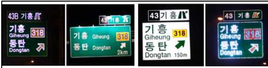
<그림 4-14> 광섬유 직 발광방식/외부조명장치 방식/ 내부조명 색변환 방식/LED 직 발광방식
