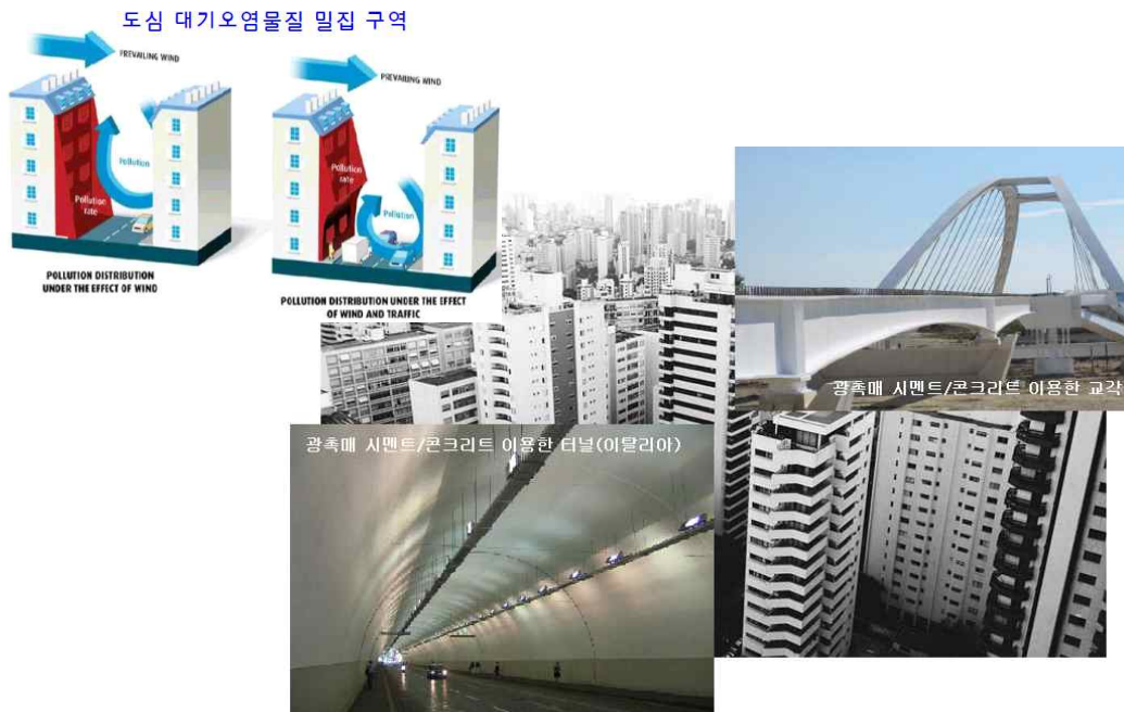
[그림 1-3] 광촉매 시멘트/콘크리트의 도시, 도로 대기오염물질 정화 기능 응용
