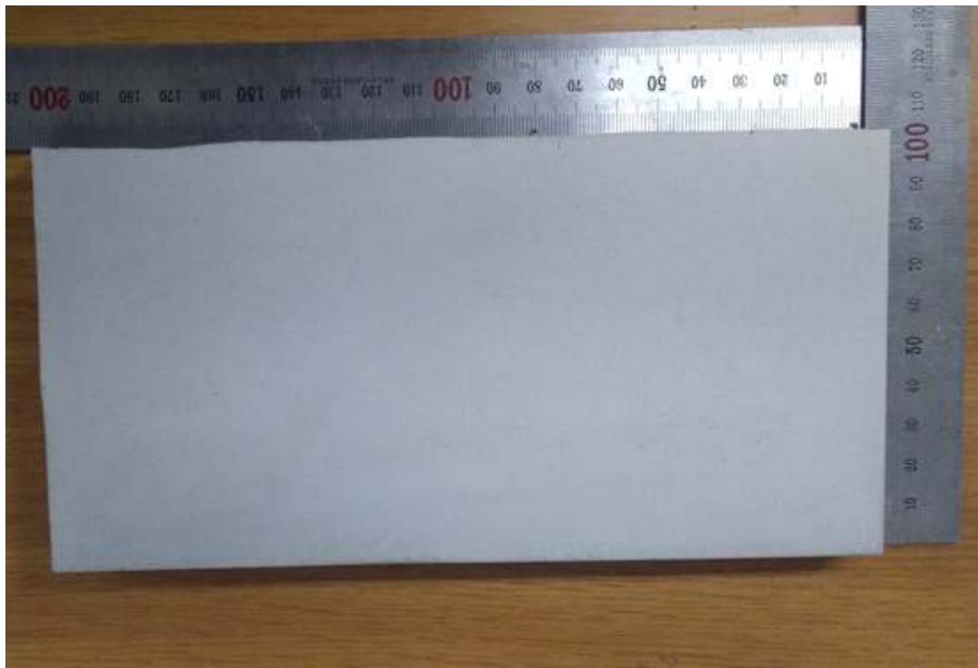
Fig.9-1. 20\text{cm} \times 10\text{cm} \times 1.5\text{cm} 대면적 광촉매 콘크리트 시편 제작.
