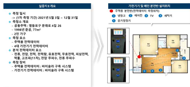
그림 40 실증지 E 설치 개요 및 계측기 설치 위치
