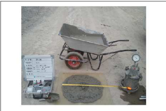
㉣ 거푸집 조립 및 콘크리트 품질검사
