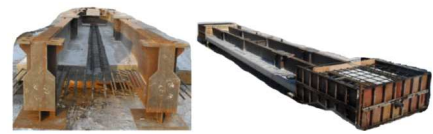
<15m 거더 시험체: 2거더 연결 시공>
