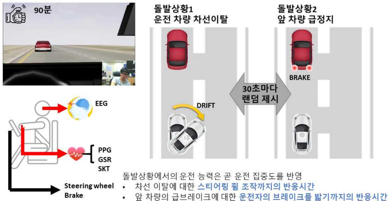
그림 14. 운전자의 전방에 1대의 차량이 존재하는 상황에서 직선도로를 무한히 주행하도록 설계됨. 돌발 상황 1: 운전자의 차량이 갑자기 차선을 벗어남.
