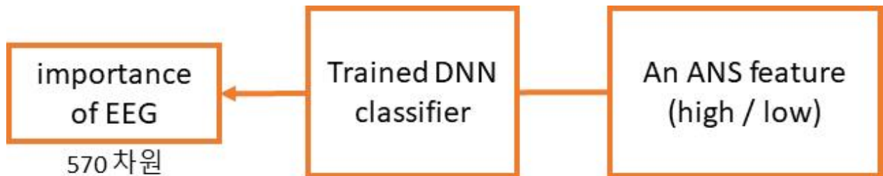
그림 42. Layer-wise Relevance Propagation (LRP)를 통해 자율신경계 신호의 높고 낮음의 분류에 중요한 요인으로 작용했던 뇌파 특징을 추적함.
