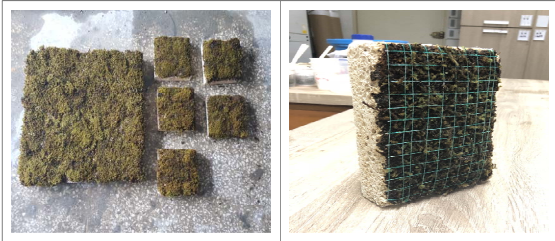
[그림 3.73] 모래이끼를 착근한 생물학적 콘크리트 판넬
