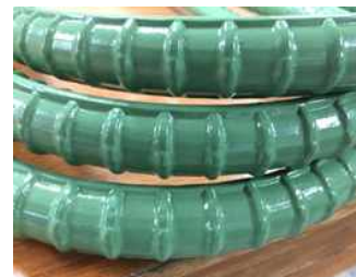
그림 2.42 패칭제 보수 후 굽힘성 시험
