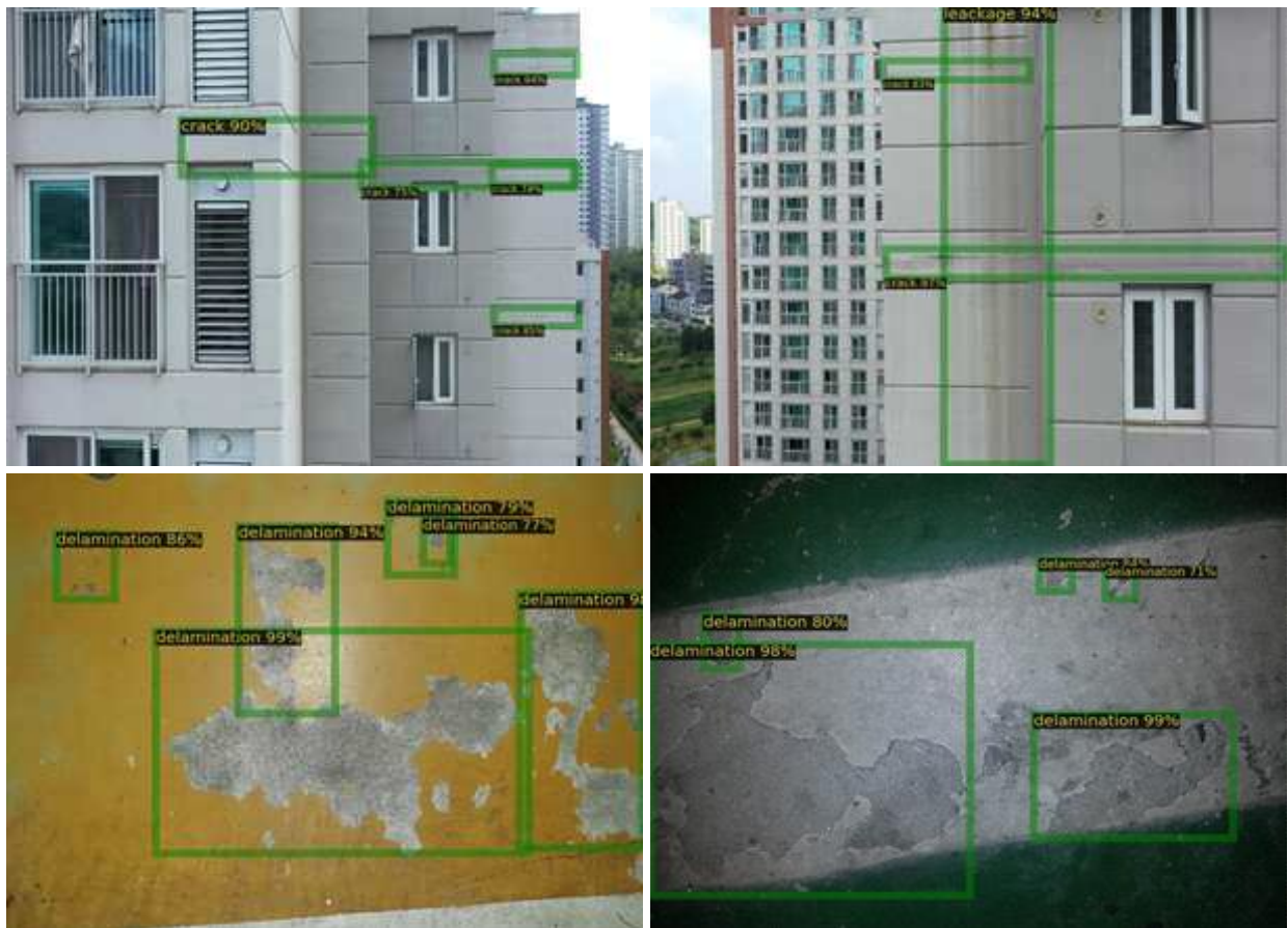
그림 2-93. 시설물 복합 하자 감지 알고리즘 (APDS_C) 결과 이미지
