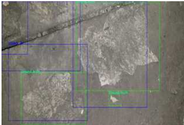
그림 2-63. Class1(도장박리) 하자 감지가 잘되지 않은 예1
