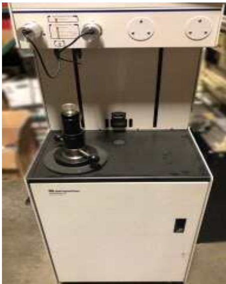
[그림 2.40] Auto Pore IV 9500 [그림 2.41] 콘크리트 수화정지
