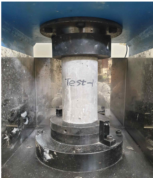
[그림 2.36] 압축강도 시험 전
