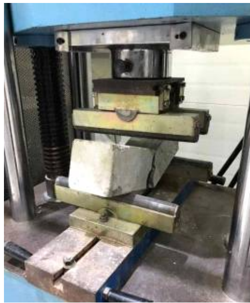
[그림 2.39] 휨강도 시험 후
