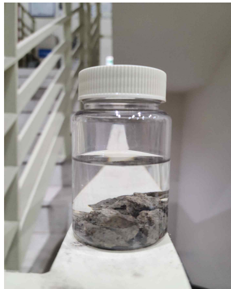
[그림 2.40] Auto Pore IV 9500 [그림 2.41] 콘크리트 수화정지
