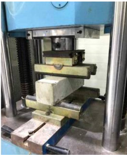
[그림 2.38] 휨강도 시험 전
