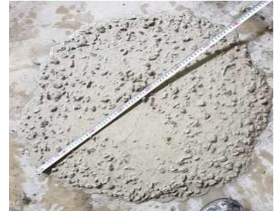
[그림 2.32] 슬럼프 플로우 시험
