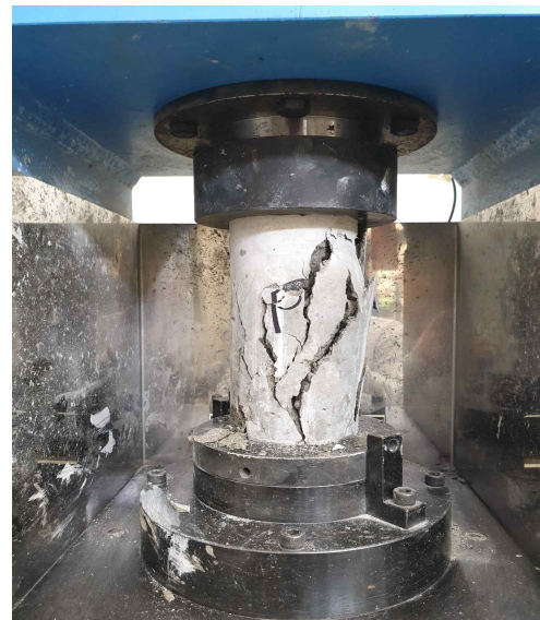
[그림 2.37] 압축강도 시험 후
