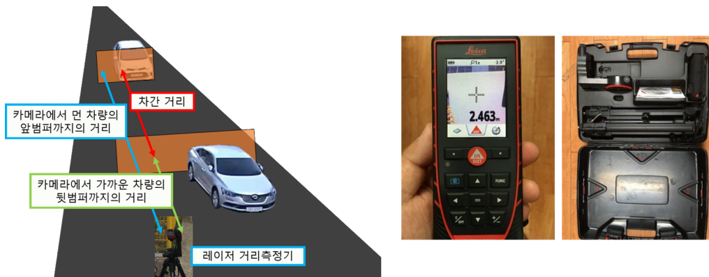
[그림] 전방 차량과의 거리 추정 실험용 DB 획득 시 실제 거리 값 측정 방법 및 측정 도구 (Leica Disto D510)
