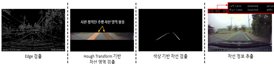
[그림] Lane Detection 알고리즘 적용사진
