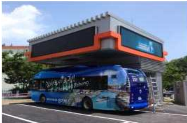
<그림 24> 배터리 교환형 전기버스(Smart e-Bus)
