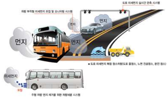
<그림 59> 도로상의 배출가스(CO 2 ) 및 미세먼지 포집 장비 시스템 개발 과제 개념도
