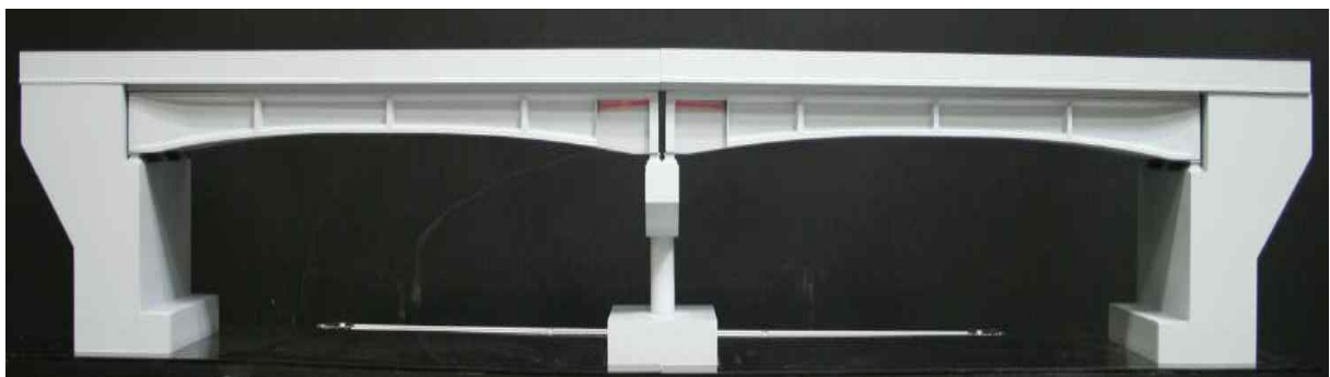
[그림 3.1.13] 변단면 PC-빔 L=2@40m=80m 연속교 축소형 모델 시작품
