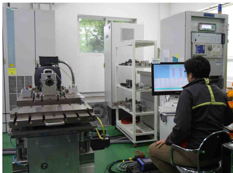
그림 3.3.26 정격운전 토크 및 효율 시험평가 사진
