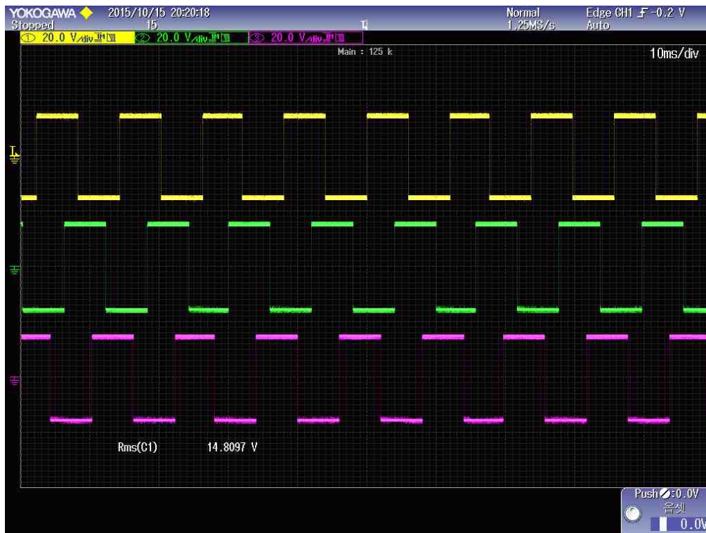
그림 5.2.3 IGBT 게이트 출력 파형 확인(U,V,W)
