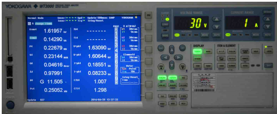
그림 3.3.25 인버터 효율측정 시험_전력분석계
