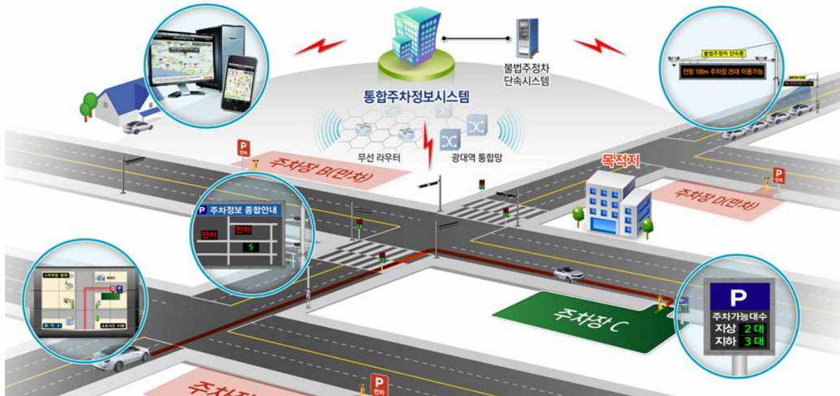
(그림. 66) 통합주차정보시스템 제공서비스 개념도(기본서비스)
