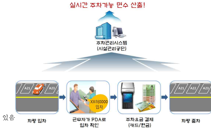
(그림. 9) PDA 기반 주차정보 수집 방식
