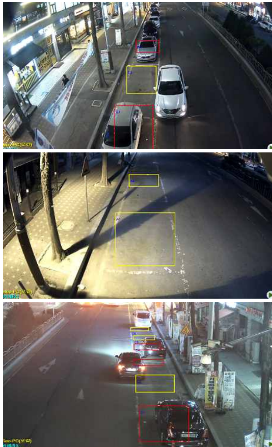
(그림. 145) 노상주차장 검지정확도 시험화면 (낮은조도)
