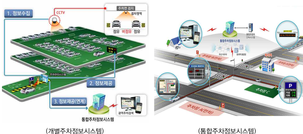
(그림. 62) 개별주차정보시스템과 통합주차정보시스템의 개념
