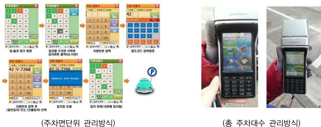
(그림. 10) 노상주차장 주차정보 수집 PDA UI
