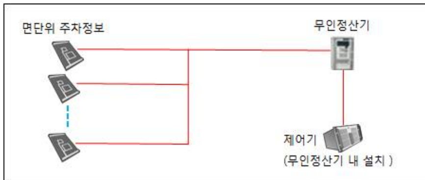
(그림. 213) 목동 부영그린노상주차장 주차정보시스템 구성도
