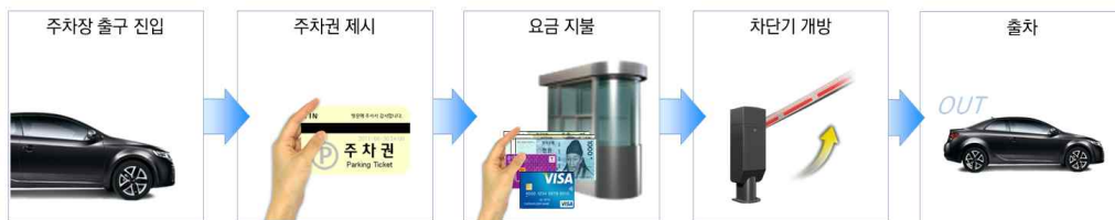
(그림. 12) 입·출차 계수 기반 주차정보시스템(유인)
