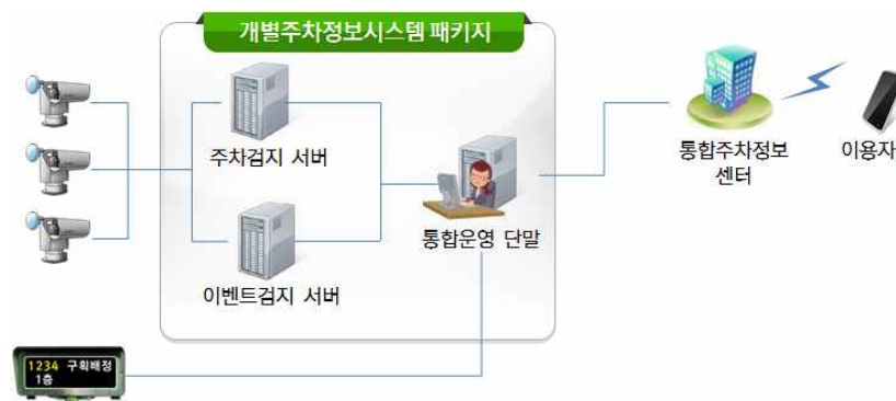
(그림. 73) 개별주차정보시스템 패키지 구성
