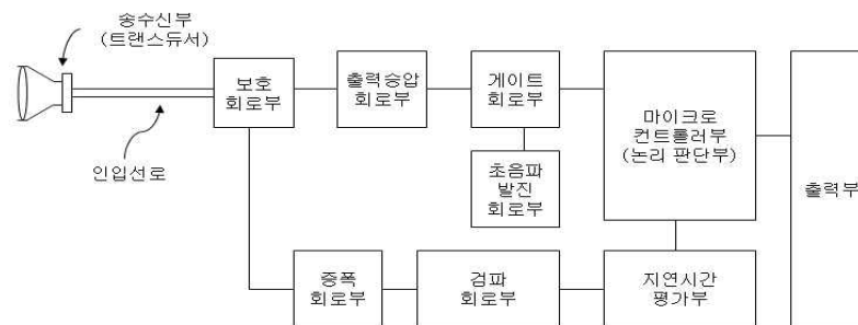
(그림. 18) 초음파센서 방식 주차검지기 블록다이어그램
