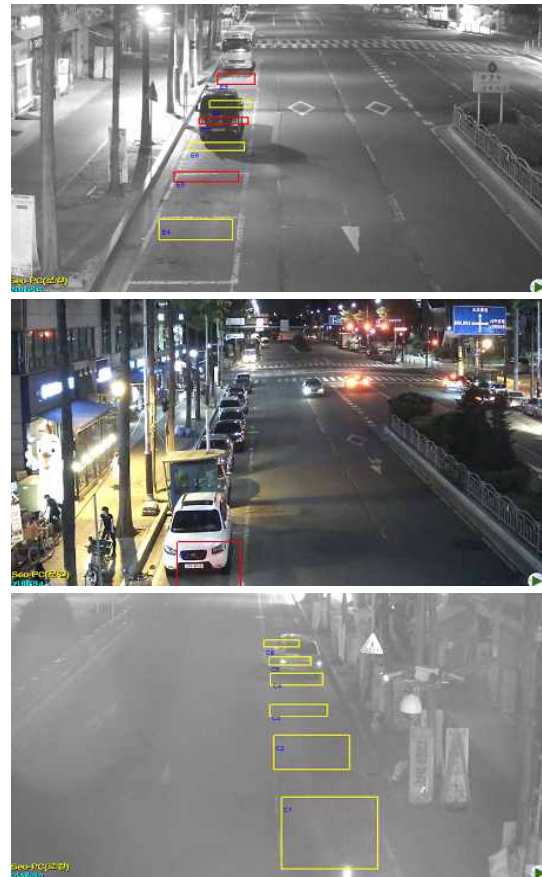
(그림. 145) 노상주차장 검지정확도 시험화면 (낮은조도)
