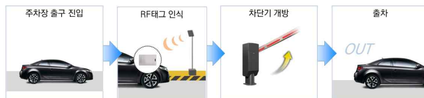
(그림. 13) 입·출차 계수 기반 주차정보시스템(무인)
