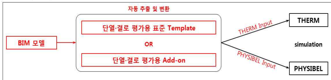
그림 3.6 BIM기반 단열·결로 해석시스템 변환 프로세스 (대안1)
