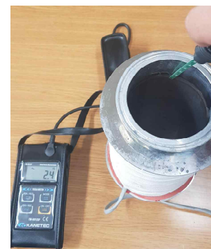
(d) 마그네틱 강도 측정
