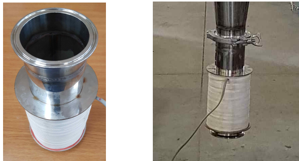
그림 1.10 부착형 마그네틱 타설 노즐 제작 및 부착 예시
