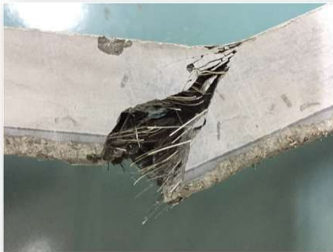
그림 1.3 강섬유 보강 콘크리트 예시
