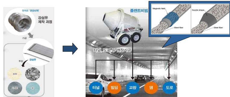
그림 5.1 강섬유 제작 및 강섬유 보강 콘크리트 현장 시공
