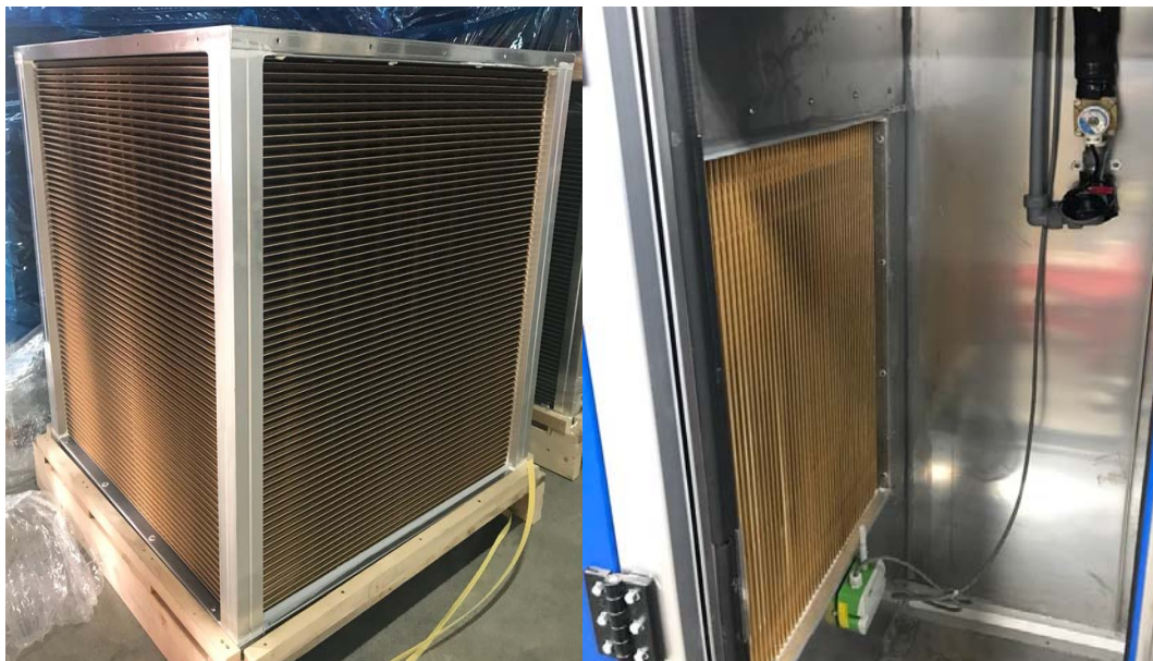
그림 97. 패키지 유닛 시제품 간접식 증발냉각기 열교환기 및 솔레노이드 밸브 적용 사진
