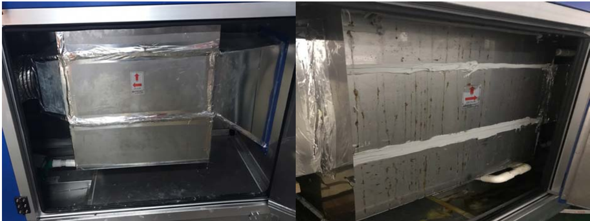
그림 54. 제습 및 재생기 수용액 누출에 따른 케이싱 부식
