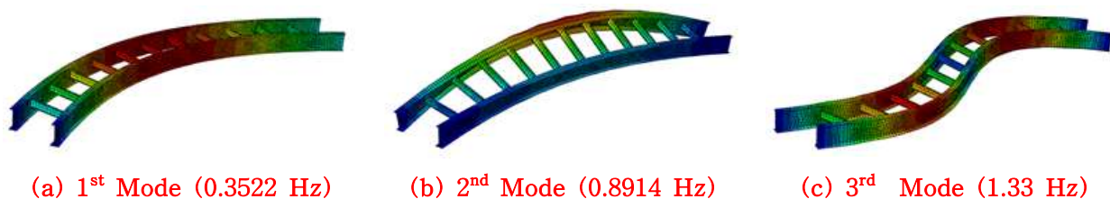
그림2.14.10 중심각 \theta = 30^{\circ} 인 거더에서의 고유 진동 특성
