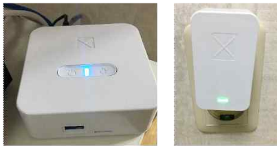
[모션 센서 허브 및 노드 설치 모습]
