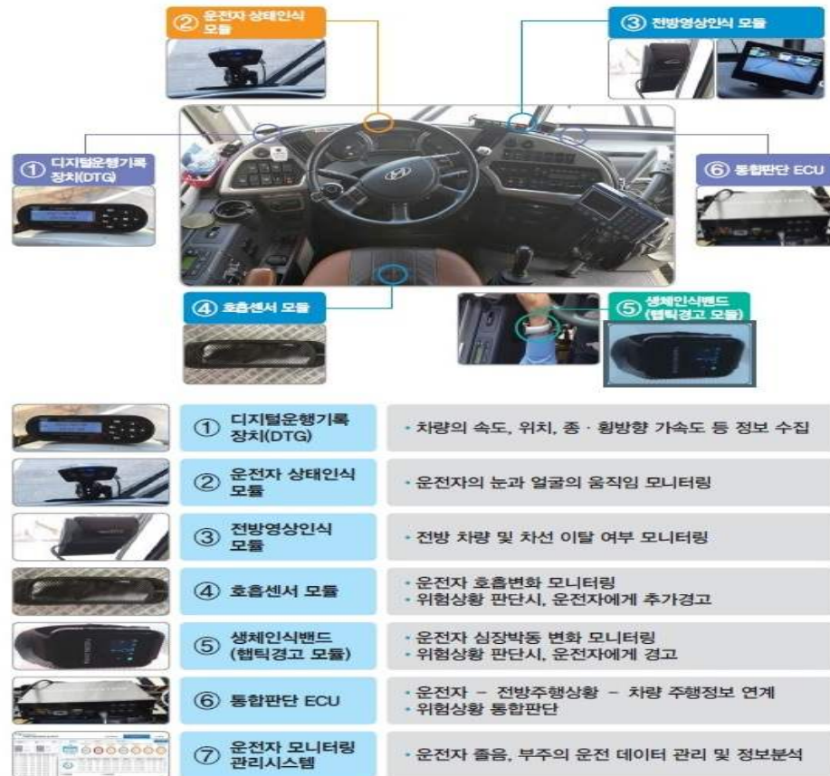
[그림 4] 운전자 위험상황 모니터링 시스템 개별모듈 개요
