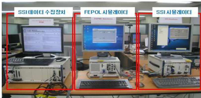
그림1-3. 플랫폼 검증을 위한 구축장비 예, 경부고속선 SSI국산화 사업
