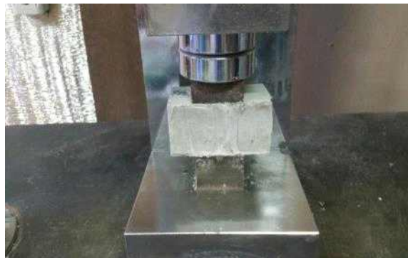
압축강도 측정완료 전경
