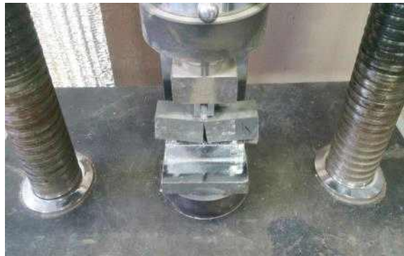
휨강도 측정 완료 전경
