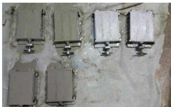
휨강도 및 압축강도시료 제작완료 전경
