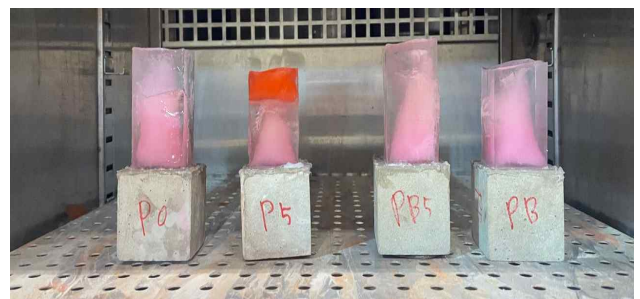
[그림] 얼음부착강도 측정용 시편
