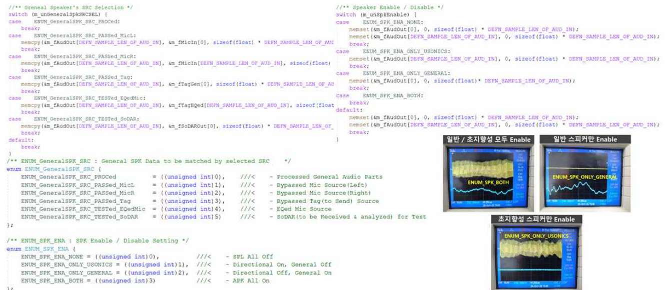
그림 19. 일반 음원 종류 선정 및 송출 스피커 Enable/Disable
