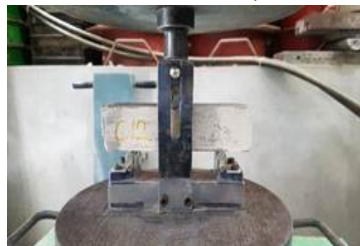
(d) Flexural strength tests set-up
