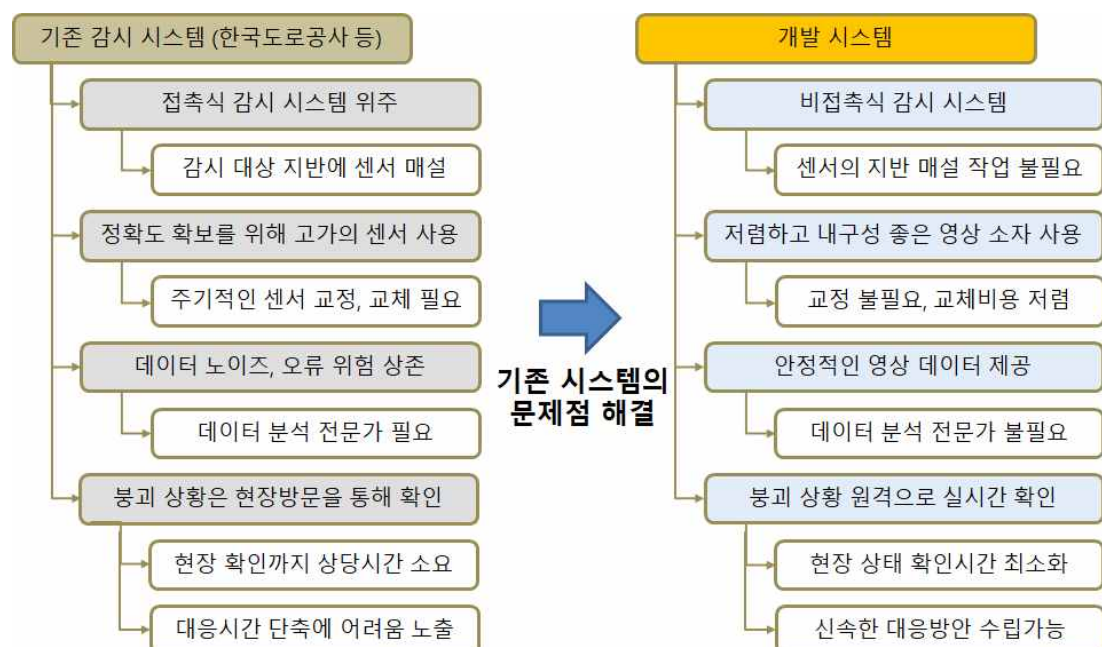
<그림 84> 기존 산사태 감시 시스템과 연구개발 시스템 비교
