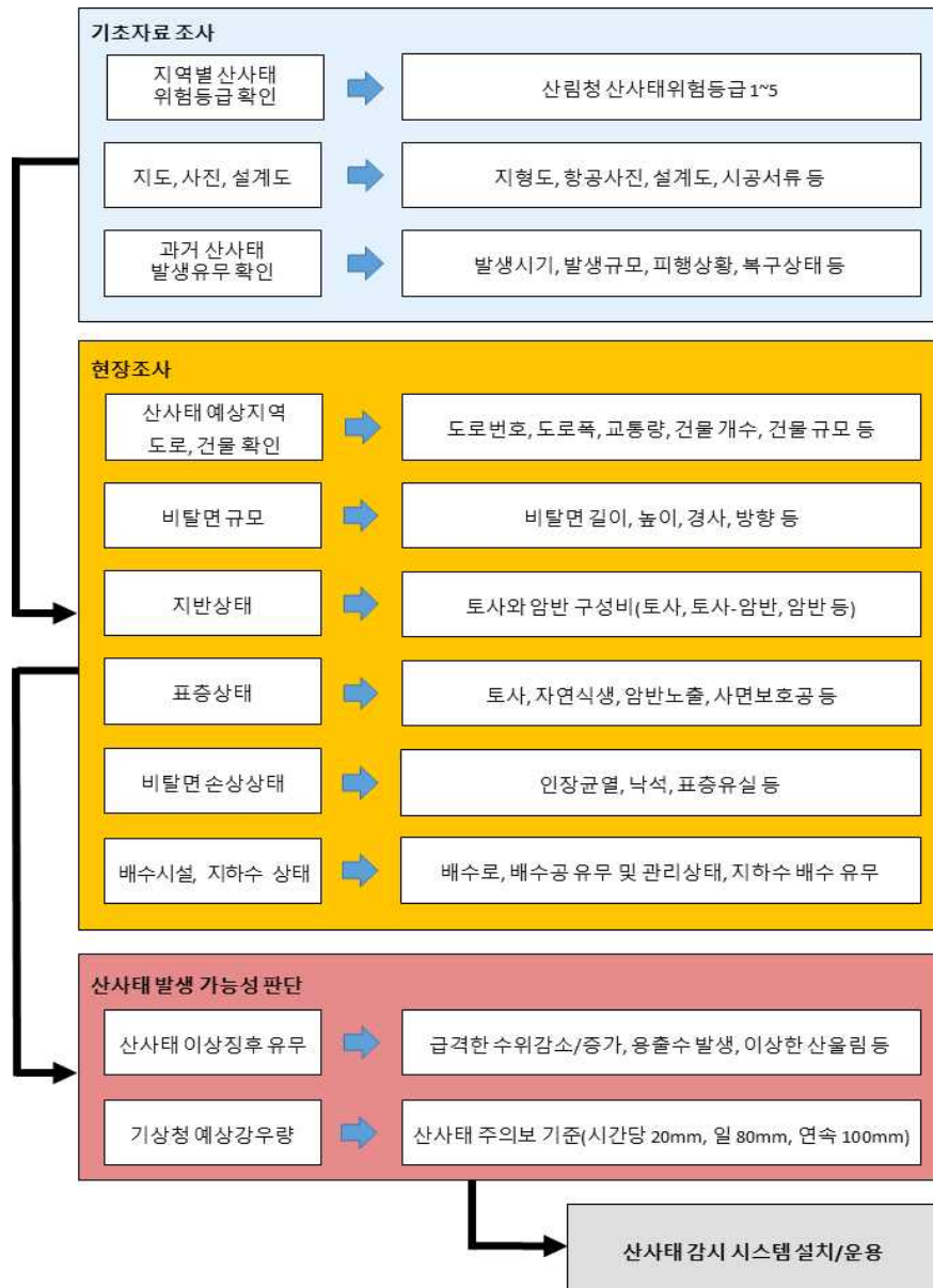
<그림 5> 개발 시스템의 설치대상 표층 붕괴 위험지점 선정 절차
