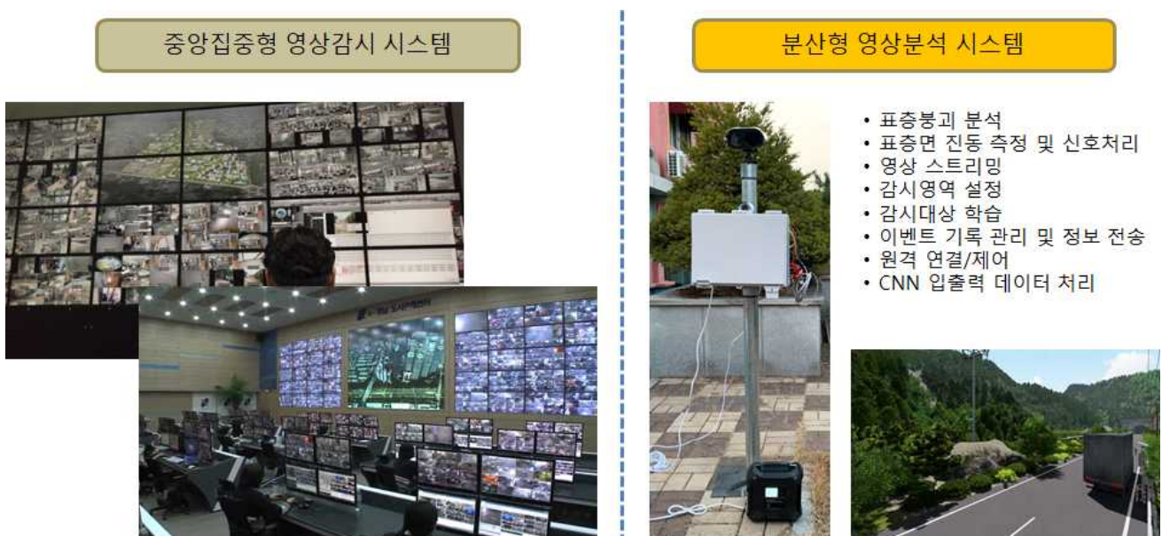
<그림 86> 중앙집중형과 분산형 영상분석 시스템
