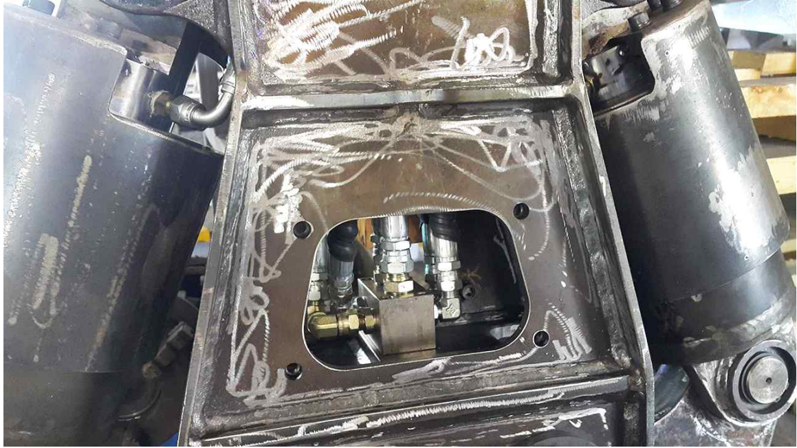
<그림 37> 제작 중인 거품분사용 압쇄기 내부
