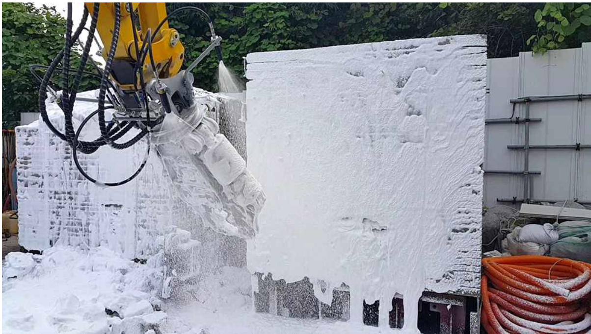
<그림 31> 노즐 각도를 조절하며 분사 테스트
