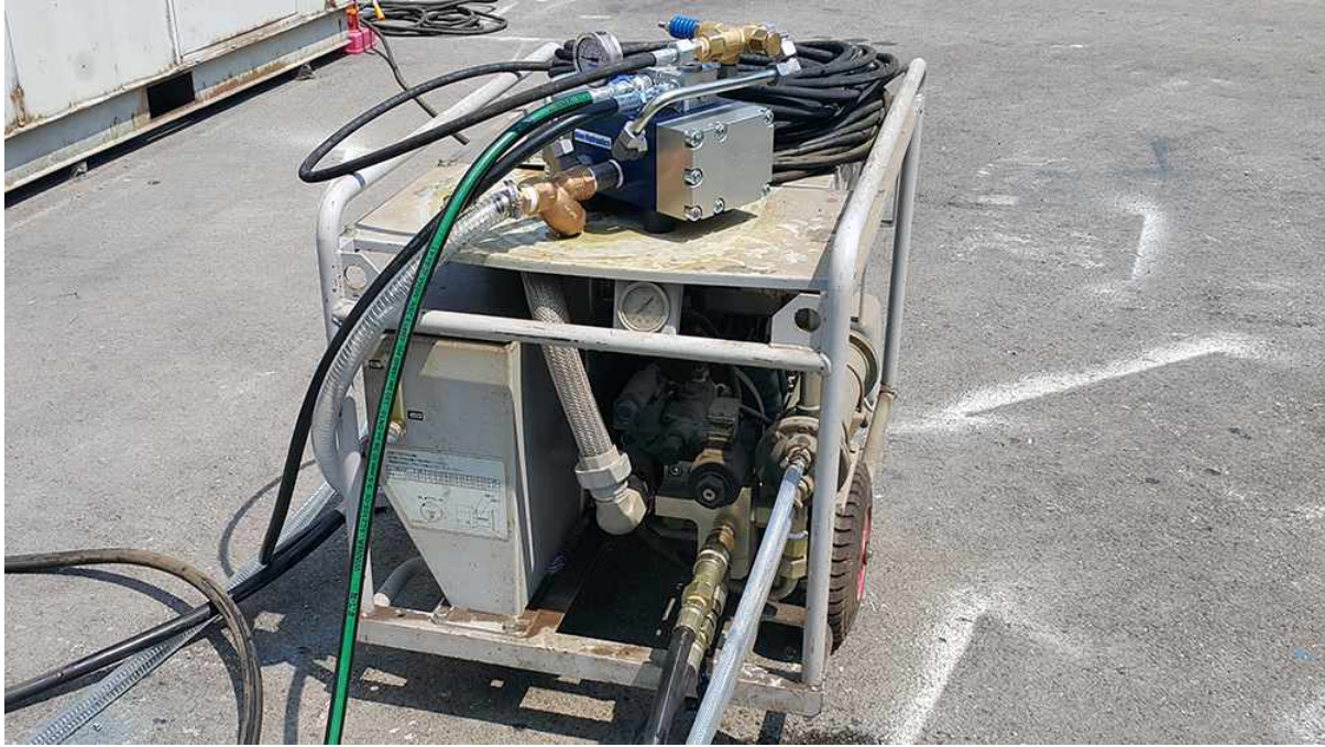
<그림 21> 유압식 고압펌프 (Dynaset사 HPW220제품)
