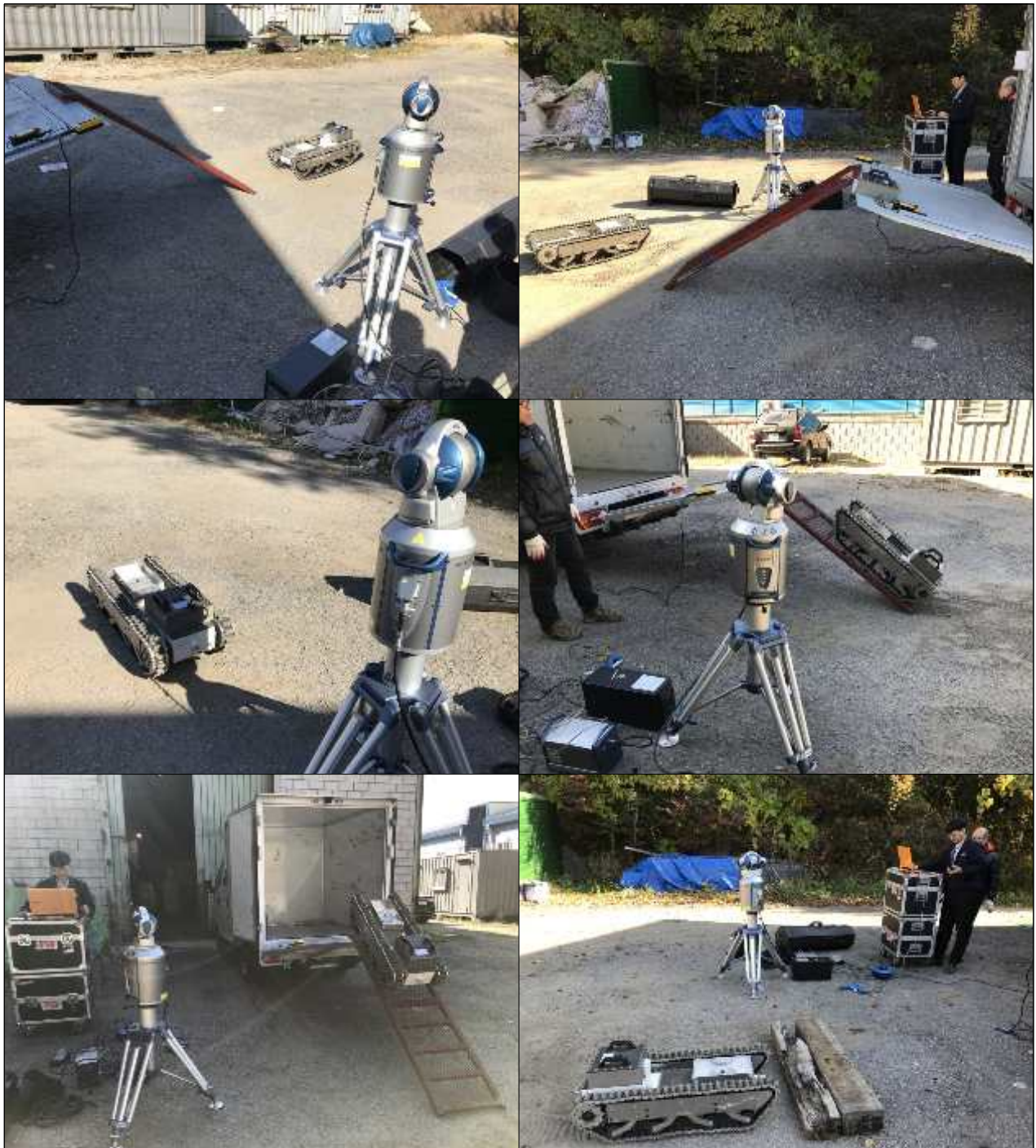
그림 [3-1-24] 궤도형 탐사장비 성능인증 시험
