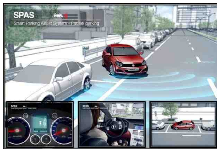
그림 2.5 만도의 초음파 기반 주차조향 보조시스템
