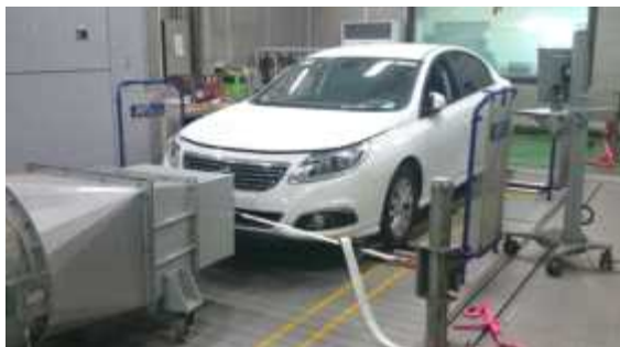
[그림 166] 차대동력계 상에 설치된 가솔린 시험 차량
